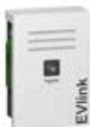
**EVW2S22P22R EVlink Parkplatz 2Wand 2x22 kW T2 RFID | EVLink Parkplatz 2 Wand, Wand-Ladestation - 2 Ladepunkte. EVLink Parkplatz 2 Wand RFID. max. Ladeleistung 2 x 22 kW, Typ 2 x 2, TE 3P+N. Für halböffentliche Garagen und Parkplätze. Für den Innen- oder Außenbereich (IP54). Zugriffskontrolle mit RFID (abschaltbar). OCPP Kommunikation mit einem Backend. Ethernet + optional GPRS. Stromzähler + Modbus für externen MID Energiezähler.**
