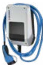
**AMTRON Compact 3,7/11** | Ladung nach Mode 3 (DIN EN 61851), Steckvorrichtung nach IEC 62196, Fest angeschlagenes Ladekabel Typ 2 (5 m Länge), Ladeleistungen bis zu 3,7 kW (1ph) / 11 kW (3ph), Statusinformation per LED-Infofeld, Anschlussfertig verdrahtet. Funktionsumfang: Potenzialfreier Eingang für eine externe Autorisierung oder um Downgrading der Ladeleistung für ein einfaches Lastmanagement (einstellbar auf 0A-6A-8A-10A-13A)
