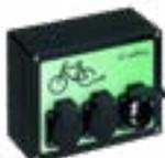
**Spelsberg Fahrradladestation** | Fahrradladestation, schwarz, inkl. Deckelschrauben mit Sonderkopf, Leitungseinführungen, 1 x M25 Gehäuserückseite, 1 x M25 untere Gehäuseseite, 1 x Belüftungsstopfen M20, vorverdrahtet auf Klemme Wago 221 (L1/L2/L3/N/PE)
